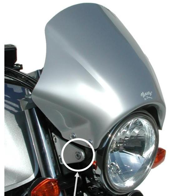
Vis de fixation du saute-vent
